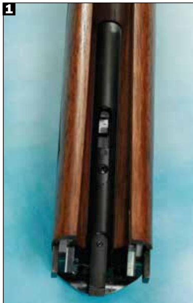
1. La croce è dotata anche di un sistema con vite per il recupero del gioco in caso di estrema usura. 2. L'arma è fornita in un'elegante valigetta in plastica di colore verde, dotata di olio di pulizia, chiave di smontaggio per il calcio, strozzatori e tracolla di trasporto. 3. Il fucile equipaggiato di canne lunghe 760 millimetri ha un peso complessivo di 3.946 grammi.
